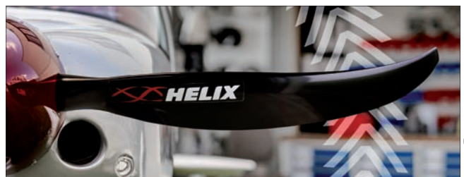
Bien des hélices modernes ont adopté un profil SCIMITAR. La nouvelle hélice Talon d'Helix propose un profil inverse. Les premiers résultats des essais en vol sont prometteurs, et ce nouveau profil génère bien moins de bruit.
