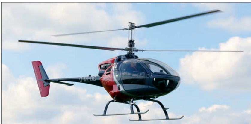
Système de rotor inusuel : après dix ans de développement, le CoAx 600 de la société allemande EDM Aerotec, avec son entraînement coaxial, est désormais certifié.
