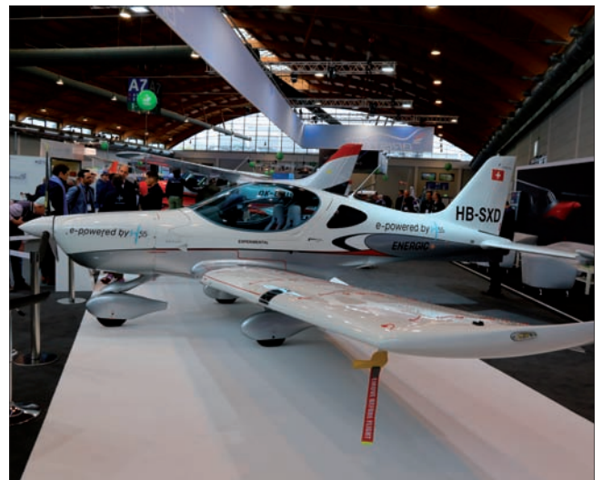
Bristell B23 Energic avec un moteur H55, en cours de certification EASA Part-23.
