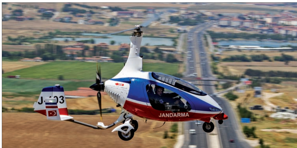
Le Jandarma Cavalon Sentinel avec Rotax 916 iS et équipement de surveillance.
