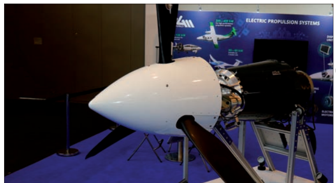
La société tchèque MGM Compro a commencé par intégrer des moteurs électriques existants dans les avions légers. Maintenant, ils ont créé leur propre ligne de moteurs et ont développé un moteur de 400 KW, capable de remplacer une turbine PT6 utilisée par de nombreux fabricants d'avions de transport régional. Cete nouvelle solution électrique est dimensionnée pour une installation sans modifications sous le capot.
