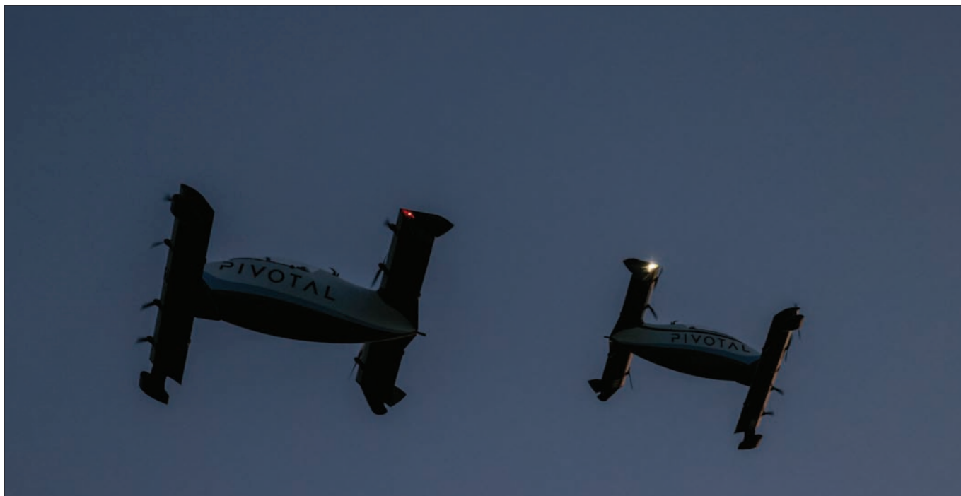
Deux hélices pivotantes ont réalisé le premier passage en formation eVTOL au monde lors d'un salon aéronautique. Cet Ultraléger de la Partie 103 est le premier eVTOL pouvant être acheté et piloté légalement aux États-Unis. Comme aucun permis ou TC n'est requis, pour éviter les accidents, la société exige un cours de formation de dix jours pour toute personne souhaitant l'acheter ou le piloter.
