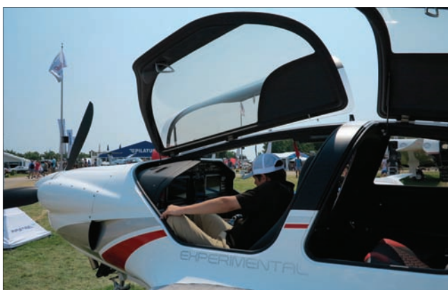
Le Pipistrel Panthera (en attente de certification EASA) était exposé dans la section eAviation du stand de Textron. La première version sera propulsée par un Lycoming IO-540V-V4A5 de 260 chevaux. Cependant, une version hybride et une version entièrement électrique, chacune avec un groupe motopropulseur de 200 kW, sont prévues. Actuellement, l'avion est disponible en kit.
