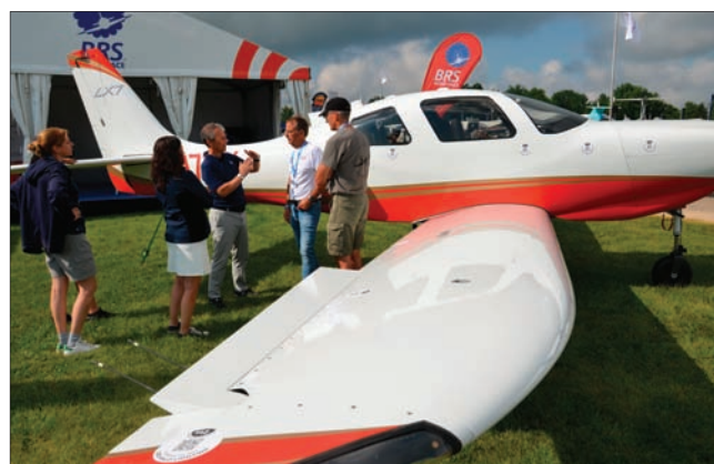
La société LX7 Aircraft Co. convertit le Lancair IV pressurisé en un avion 4 places ultra-performant équipé soit d'un moteur à piston Continental TSIO-550-E, soit d'une turbine PT-6. Comme la gamme Cirrus, cet avion est également équipé d'un parachute balistique pour tout l'avion de type BRS.
