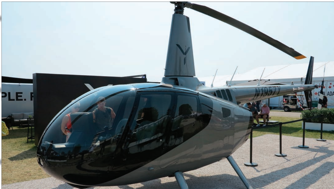
La proposition MOSAIC de la FAA permettra les hélicoptères LSA. La règle préliminaire actuelle stipule que de tels aéronefs à rotor doivent avoir une interface pilote simplifiée. Skyrise est une entreprise proposant un tel produit. Sa modification du Robinson R-66 peut être pilotée avec un simple joystick relié à un système de commande de vol par fil, la certification est en cours.
