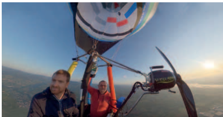
Une montgolfière qui se transforme en dirigeable ultraléger grâce à un moteur électrique à hélice orientable.
