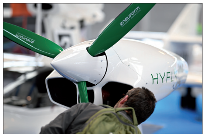
Der von HyFly entwickelt E-Antrieb mit Brennstoffzelle für UL und Motorsegler.
