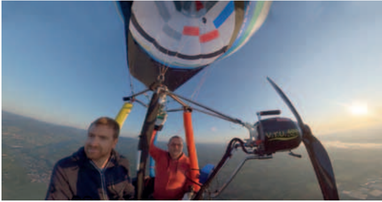
Ein Heißluft-Ballon, der Dank eines lenkbaren e-Motors mit Propeller zum ultraleichten Heißluft-Luftschiff wird
