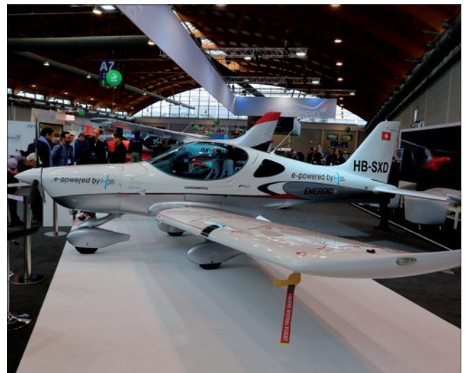
Bristolls B23 Energic mit einem H55 Motor für die EASA Part 23 Klasse.
