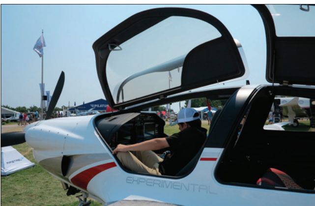
Der Pipistrel Panthera (der noch auf die EASA-Zulassung wartet) war im eAviation-Bereich des Textron-Standes zu sehen. Die erste Version wird von einem Lycoming IO-540V-V4A5 mit 260 PS angetrieben. Es sind jedoch sowohl eine Hybrid- als auch eine vollelektrische Version mit jeweils 200 kW Triebwerk geplant. Derzeit ist das Flugzeug nur als Bausatz erhältlich.
