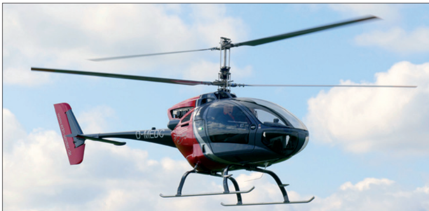
Ungewöhnliches Rotorsystem: Nach zehn Jahren Entwicklungszeit erhielt der CoAx 600 der deutschen Firma EDM Aerotec mit seinem Coaxialantrieb jetzt die Zulassung.
