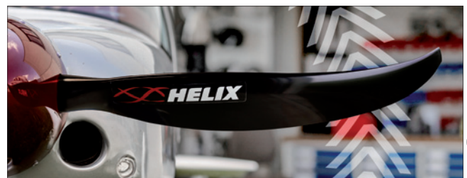
Viele moderne Propeller haben die Form eines Säbels, der sich in Bezug auf die Drehrichtung nach hinten neigt (oberes Bild). Der neue Talon-Propeller von Helix neigt sich in Drehrichtung nach vorne. Das Ergebnis: Die gleiche Leistung wie ein „gerader“ Propeller, aber viel weniger Lärm.
