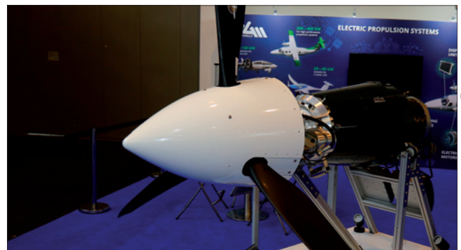
Die tschechische Firma MGM Compro begann, vorhandene Elektromotoren in kleine Flugzeuge einzubauen. Nun hat sie mit der Produktion ihres eigenen Motors angefangen und einen 400-Kw-Motor entwickelt, der die PT6-Turbine ersetzen soll, die von vielen Flugzeugherstellern verwendet wird.
