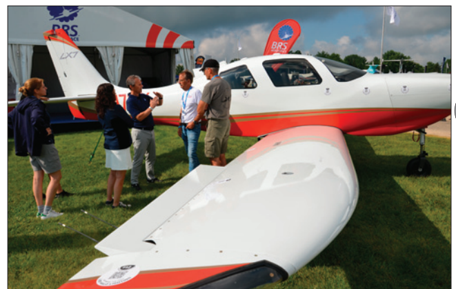
LX7 Aircraft Co. baut die Lancair IV in einen 4-sitzigen Hochleistungsfieger um, der entweder mit einem Continental TS10-550-E Kolbenmotor oder einer PT-6 Turbine ausgestattet ist. Wie die erfolgreiche Cirrus-Linie ist auch dieses Flugzeug mit einem ballistischen BRS-Fallschirmrettungssystem ausgestattet.
